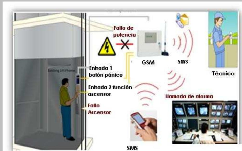
El sistema permite un monitoreo remoto vía PC o SMS continuo.
