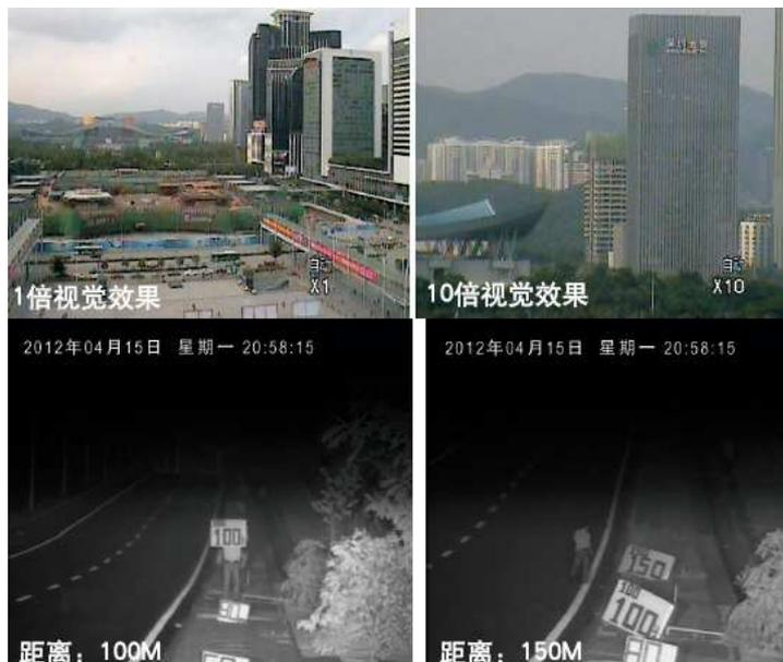
3. Sincronización automática con la velocidad del vehículo: el zoom óptico 10x también se puede sincronizar con la velocidad del coche. Cuando el coche va rápido, el zoom consigue más visión; y cuando el coche va despacio, el zoom consigue ampliar el ángulo.
