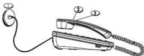
Conecte el cable de la línea telefónica, a un lado de pared y otro lado la "línea" jack del teléfono.
